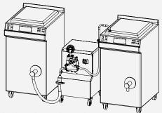
Cuando el producto alcanza la temperatura de pasteurización, 85-90°C en el primer equipo se pone en marcha el homogeneizador que a la vez transfiere el helado al segundo pasteurizador para empezar el enfriamiento.
