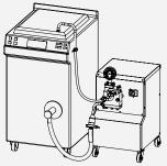
El uso del Microlab 400 con un solo pasteurizador deber en recirculación sobre este.
